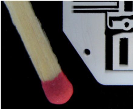
Kunststoffbearbeitung mit Wasser, Schlitz- resp. Stegbreite beträgt lediglich 1/10 der bearbeiteten Materialdicke.
